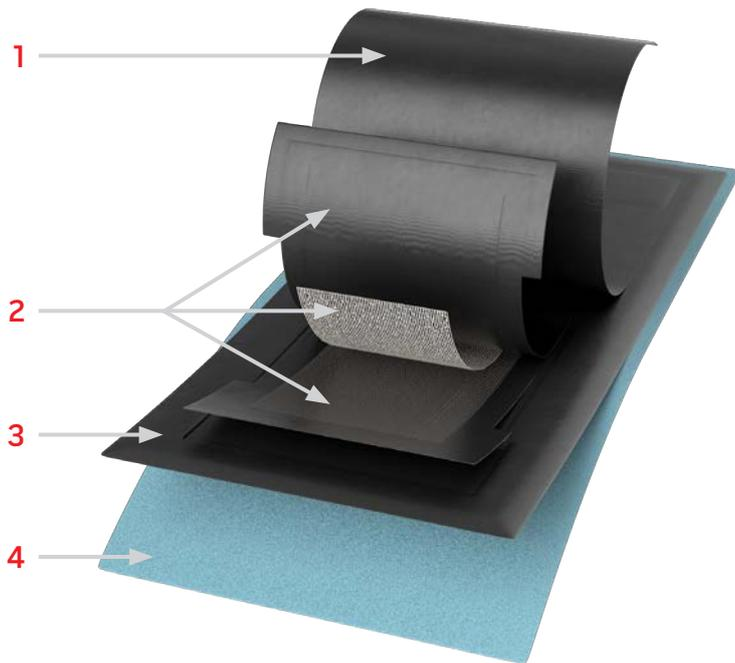
1. **Deckschicht:** verhindert Luft- und Druckverlust
